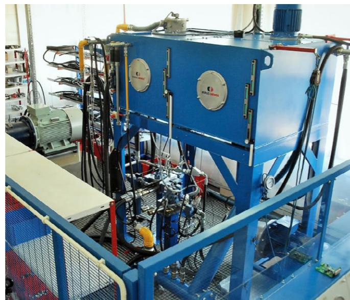
Stacja badawcza układów hydrauliki siłowej o mocy do 90 kW
