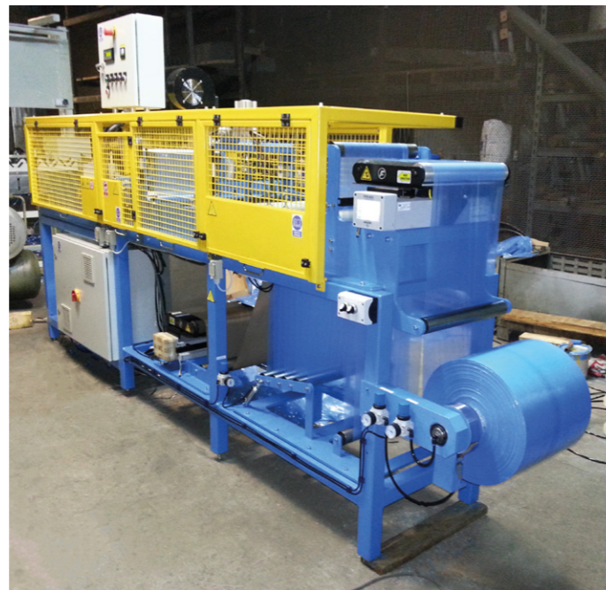
Maszyna do produkcji woreczków do lodu
