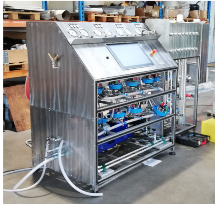
Stacja badawcza układów hydrauliki siłowej o mocy do 90 kW
