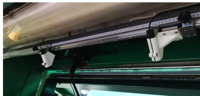
Poziomica laserowa w maszynie do produkcji taśmy gumowej
