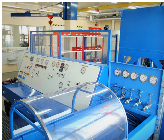
Stacja badawcza układów hydrauliki siłowej o mocy do 90 kW
